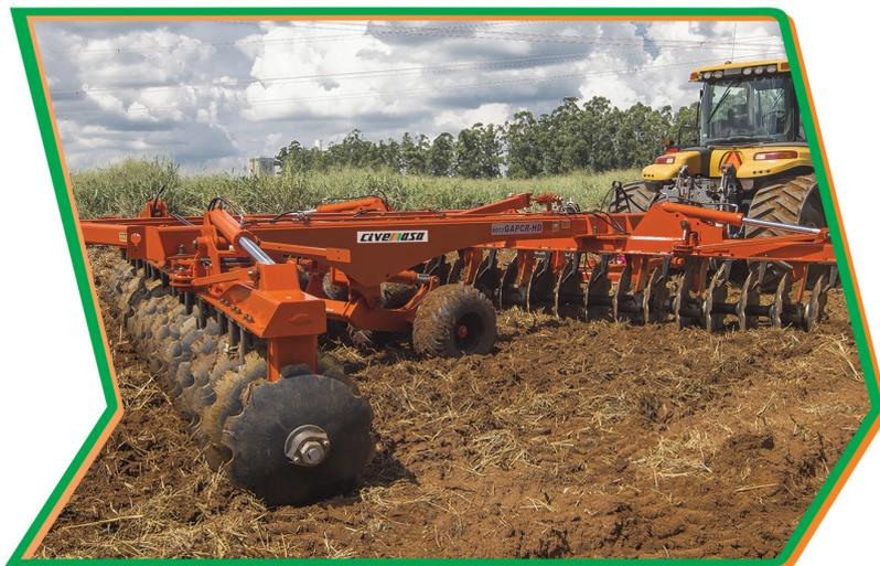
Esta grade possui uma estrutura tubular de alta resistência. Seu sistema de rodagem é muito eficiente, sendo os cubos dos rodeiros com dois rolamentos cada, além de proteção contra poeira e umidade. Ainda para facilitar o transporte e deslocamentos por estradas rurais, esta grade possui as laterais articuladas através de cilindros hidráulicos.
